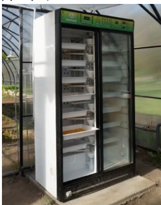
Рисунок 1 – Установка гидропоники горизонтального типа
