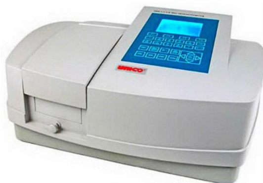
Рисунок 1 – Внешний вид спектрофотометра UNICO 2800 (спектральный диапазон 190 – 1100 нм)
