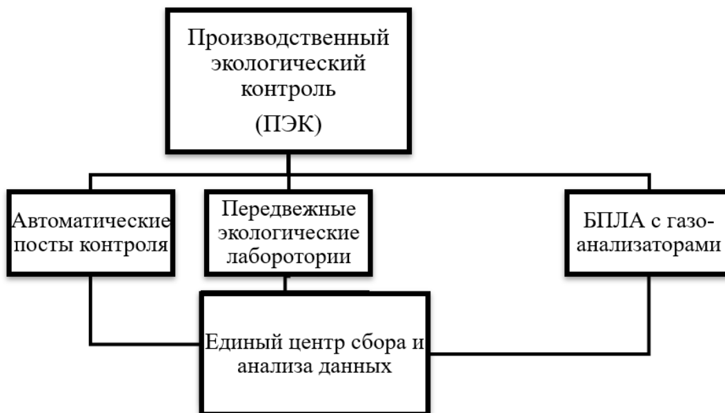
Рисунок 2 – Структура системы производственного экологического контроля на Волгоградском НПЗ
