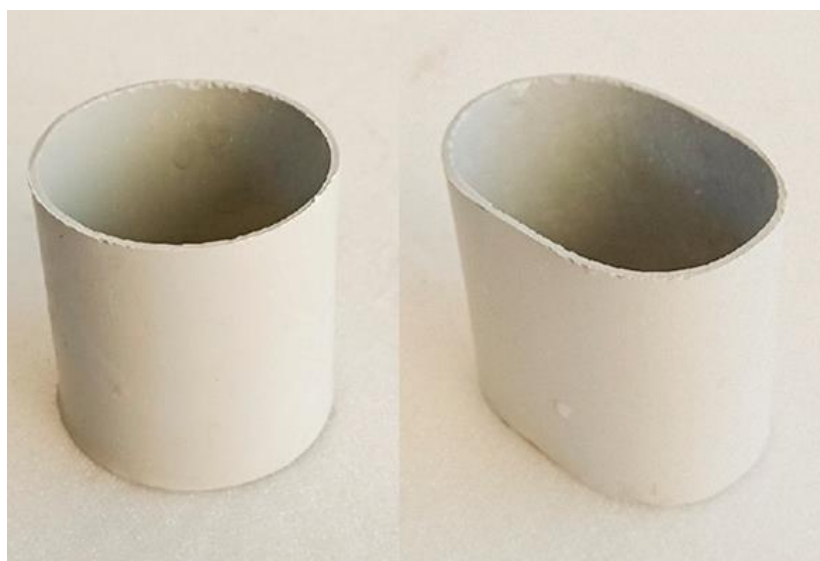
Рисунок 3 – Кольца Рашига из поливинилхлорида до проведения эксперимента (слева) и после проведения при режиме 5 (справа)
